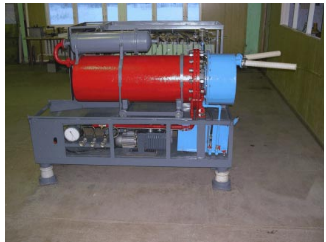
Рис. 11. Взрывной мобильный имитатор молний на основе взрывомагнитного генератора.
