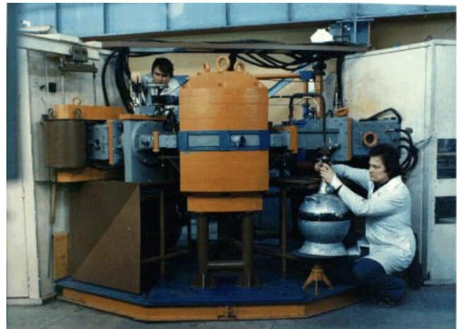
Рис. 7. Ионно-пучковый ускоритель ИЛУ. Энергия ионов — до 40 кэВ, общий ток — до 30 мА, магнитное поле — до 5500 Э. Площадь обработки 15 \times 20 \text{ см}^2 . Вид ионов — большинство элементов периодической системы.
