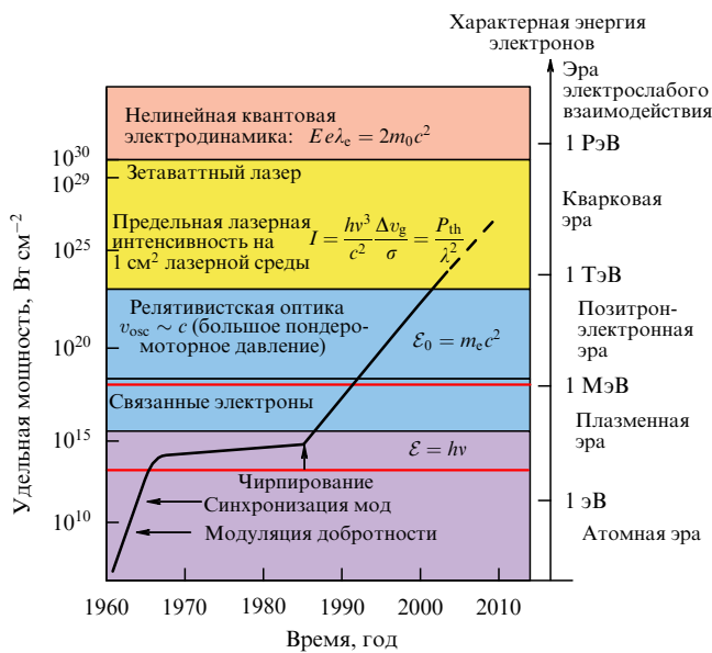
Рис. 8. Возрастание интенсивности лазерного излучения во времени [5, 27]. Быстрое возрастание интенсивности излучения в 1960-е годы привело к открытию многих нелинейных эффектов, стимулированных связанными электронами (характерные энергии ~ 1 эВ). Достигнутая сейчас интенсивность позволяет изучать процессы при релятивистских энергиях электронов ( \mathcal{E}_0 \sim m_e c^2 \sim 0,5 МэВ).
